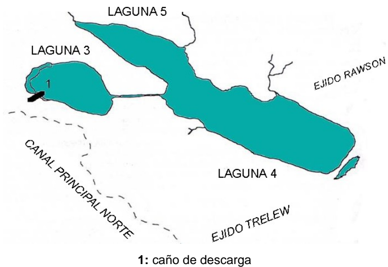
Fig. 2 Lagunas de estabilización.
